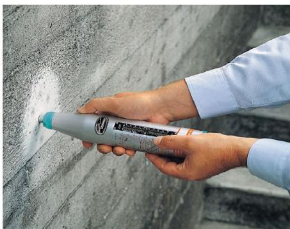
Figure 1-15 : Scléromètre ou marteau de Schmidt
