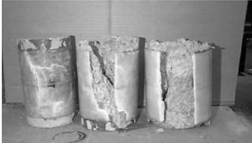
Figure 3-12: Modes de rupture d'un béton renforcé par un FRP à base de fibres de verre et de résine époxy soumis à une charge de compression [28]
