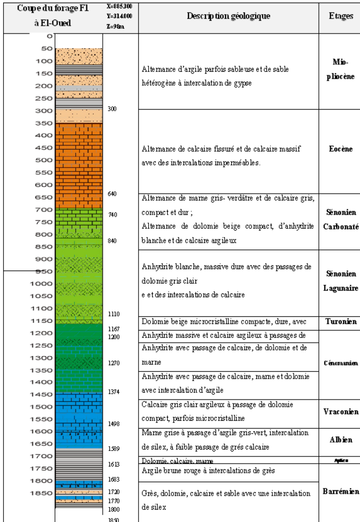
Fig.1-17 : La litho-stratigraphie du forage F1, (ANRH, 2005).
