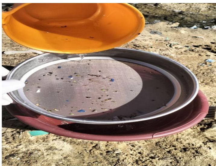
Figure 12: Opération de tamisage
