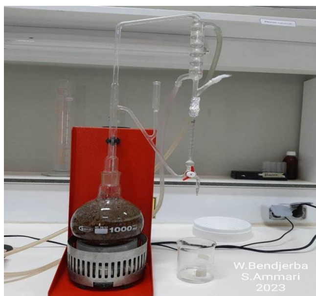
Figure15: Appareil d'hydrodistillation de type Clevenger ( original )
