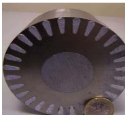
Coupe de face d'un rotor complet
