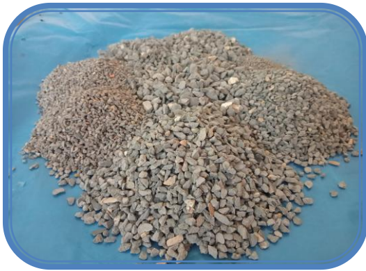
Photo III 1 : déchet de béton 'DBR' (laboratoire de G.C)
