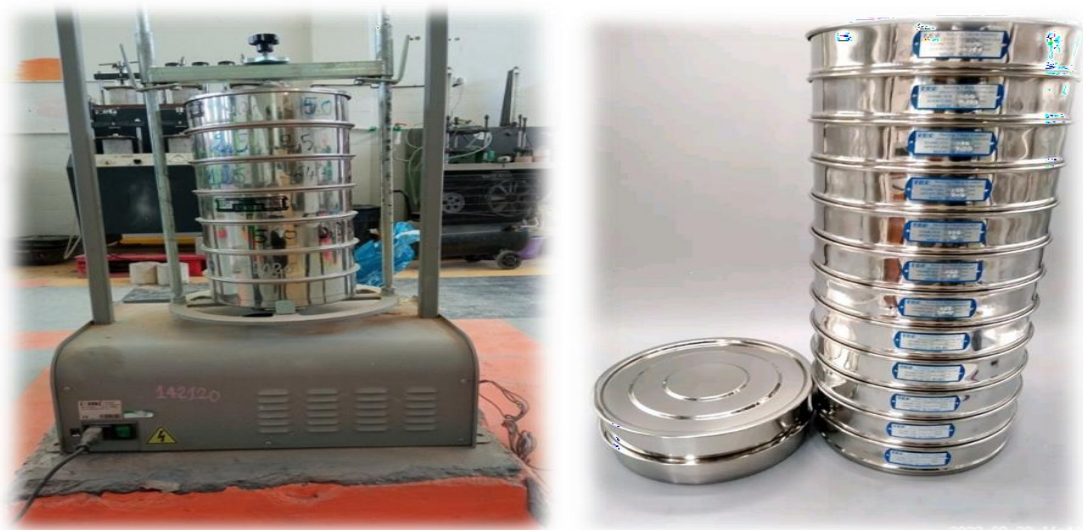
Photo (III.5): sable Analyse granulométrique. (Tamiseuse de la boratoire labo G.C ).
