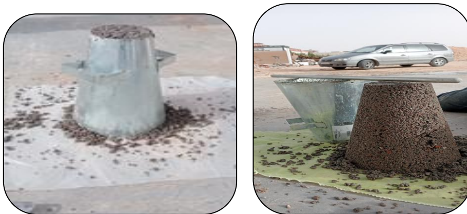
Photo(III.10):l'affaissement de cône d'Abrams d'un béton.(zone industriel el_oued)
