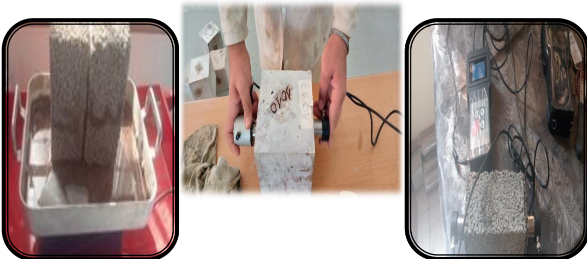
Photo (III 12): Essai d'ultrason (ultrason de la boratoire edeg.c).
