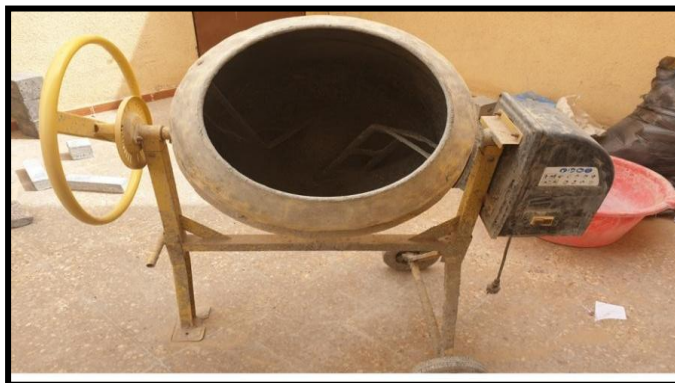
Photo(III.9) :Le malaxeur utilisé (zone industriel el_oued).
