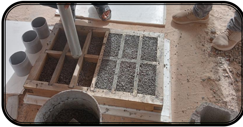
Photo (III 11): le collage de béton en utilisant marteau Proctor(zone industriel el_oued)
