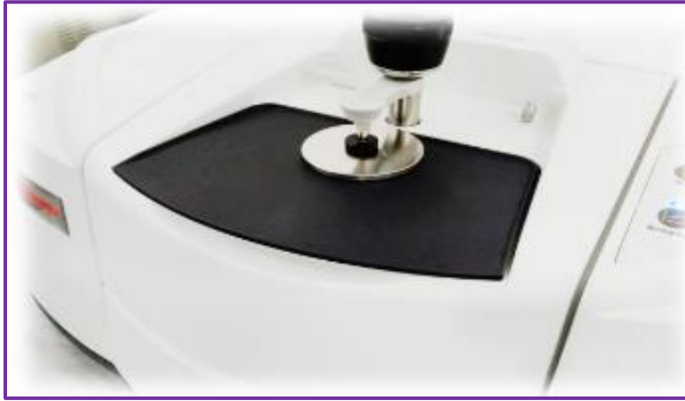
الشكل (III. 12): طريقة وضع العينات الصلبة في جهاز ATR.
