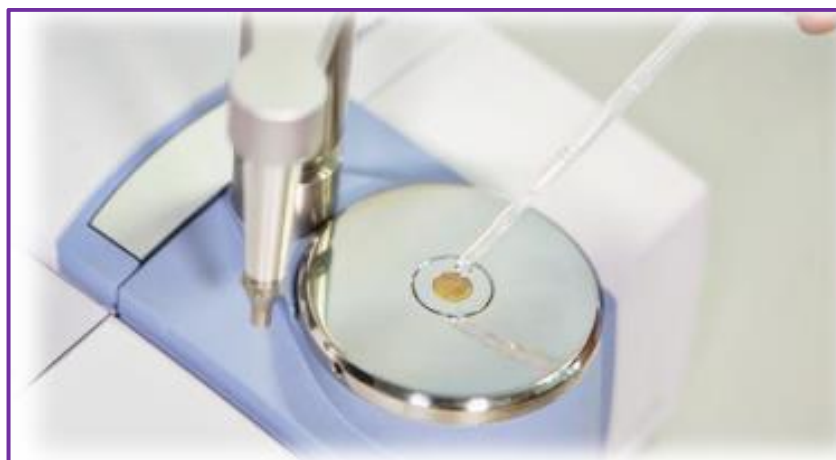
الشكل (III. 11): طريقة وضع العينات السائلة في مكان وضع العينة لجهاز ATR.
