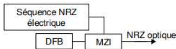
Figure II-3: le module d'émission NRZ [22]
