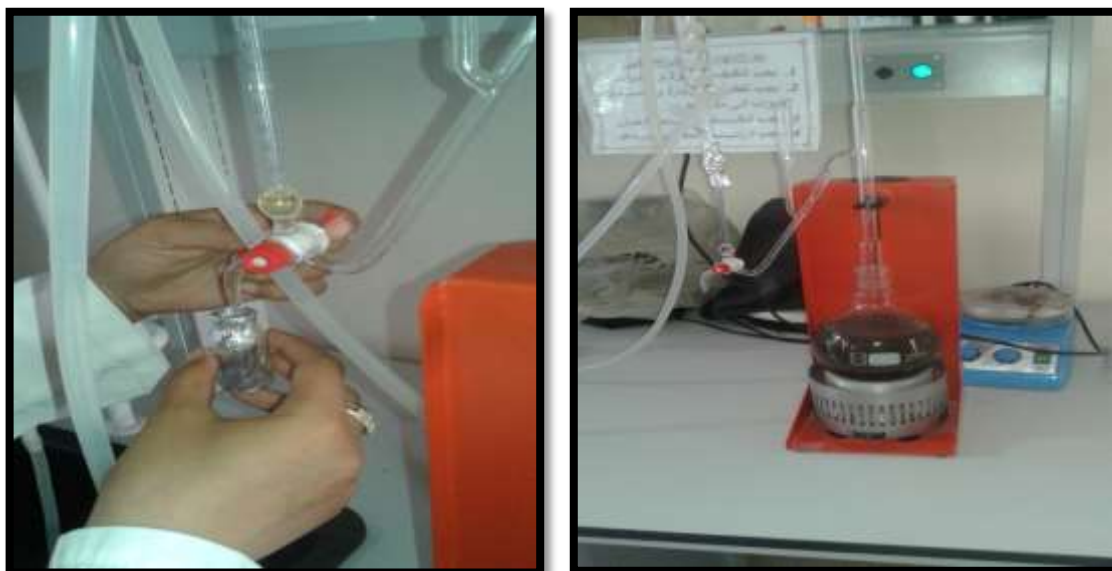
Figure 16 : Montage d'hydrodistillation (photo original).
