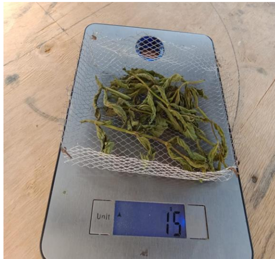
الشكل (5.3) : صورة النعناع عند أخذ كتلته خلال عملية التجفيف
