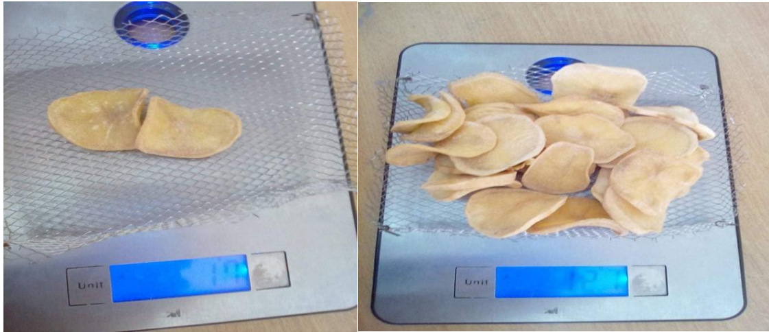
الشكل (10.3) : صورة البطاطا عند أخذ كتلتها خلال عملية التجفيف
