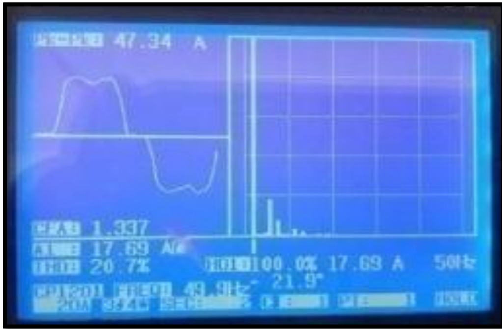
Figure(V.8) spectre d'harmonique du courant de source avant filtrage
