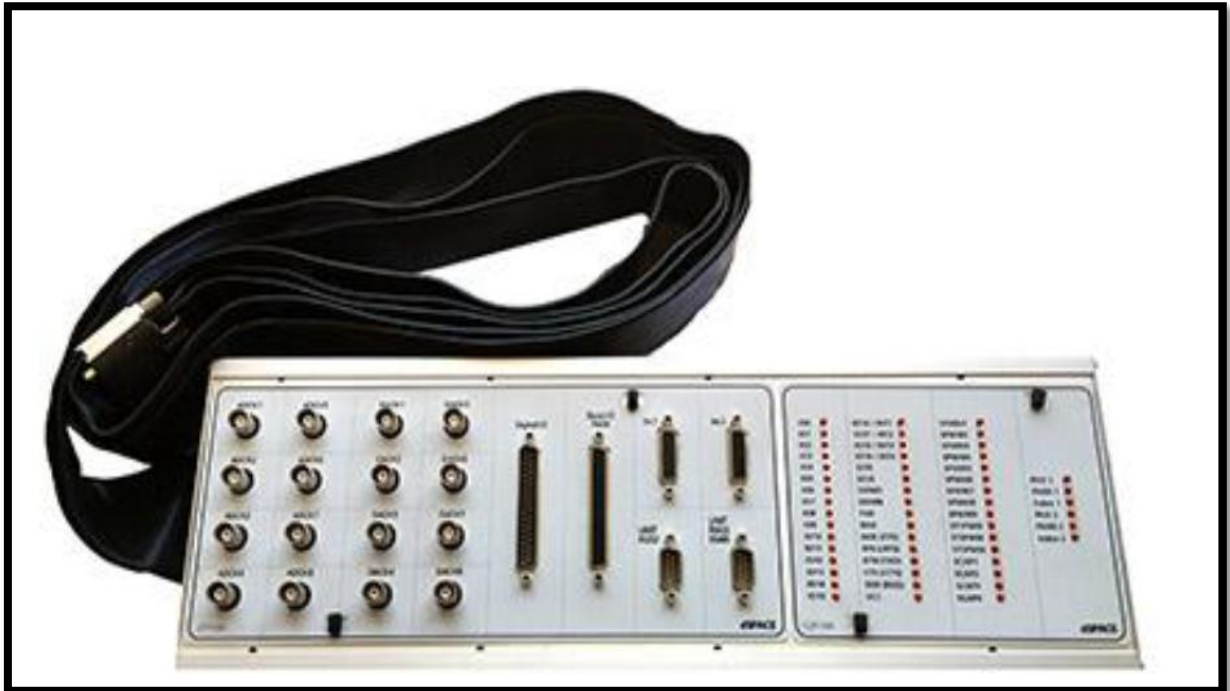
Figure(V.4) panneau de connexion CLP1104
