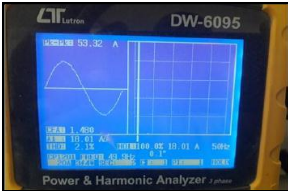
Figure(V.10) spectre d'harmonique du courant de source après filtrage
