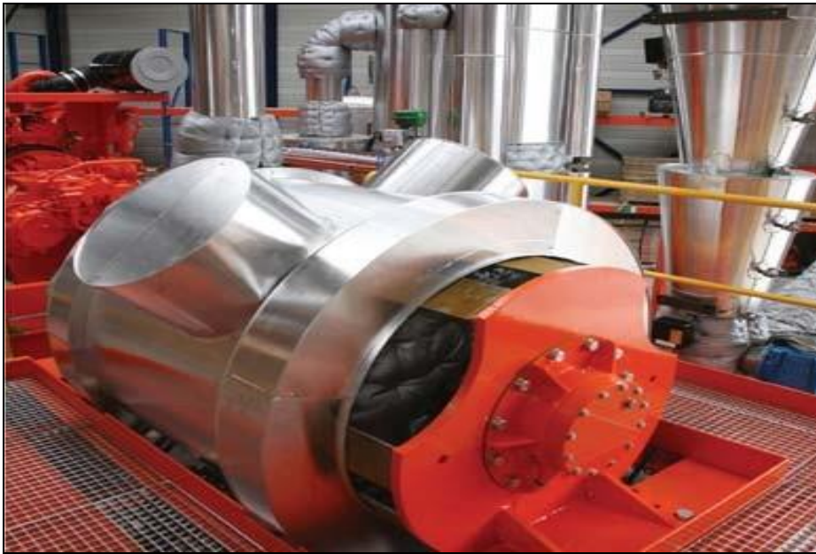
الشكل II.6: نظام الامتصاص الحراري TCC للتطبيقات البحرية أو البرية (Thermtech، 2008)
