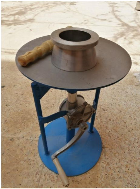
الشكل III. 2: طاولة الهز لتجربة التشغيلية.
