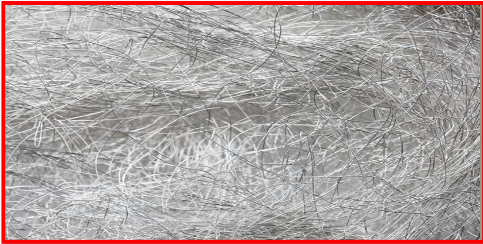
الشكل (II . 16): يمثل صورة ميكروسكوبية لأسلاك نانوية مصنوعة من السيليكون . [59]
