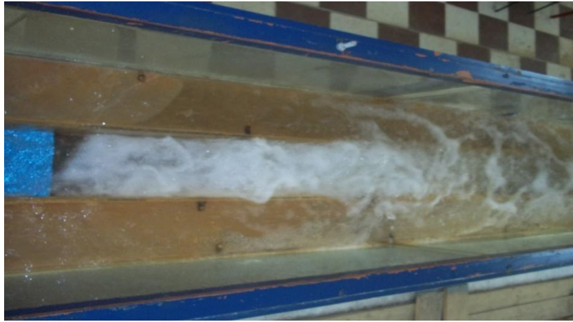
Photo II.2 : Photographie d'un ressaut hydraulique contrôlé par seuil mince F_1 = 8,24 ; s = 15 cm; h_2 = 24,9 cm ; h_1 = 2,5 cm
