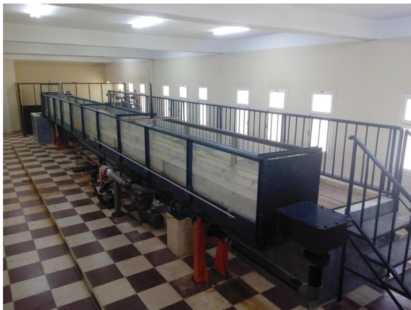
Photo I.1 : Photographie du model expérimentale du canal
