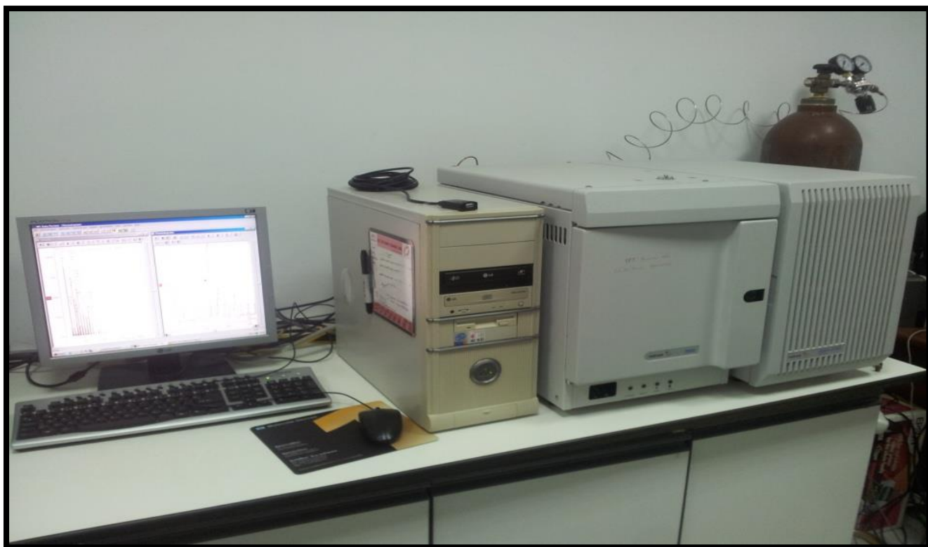
شكل 12: صورة أصلية لجهاز كروماتوغرافيا الطور الغازي المدمج مع المطيافية الكتلية (Varian Saturn)
