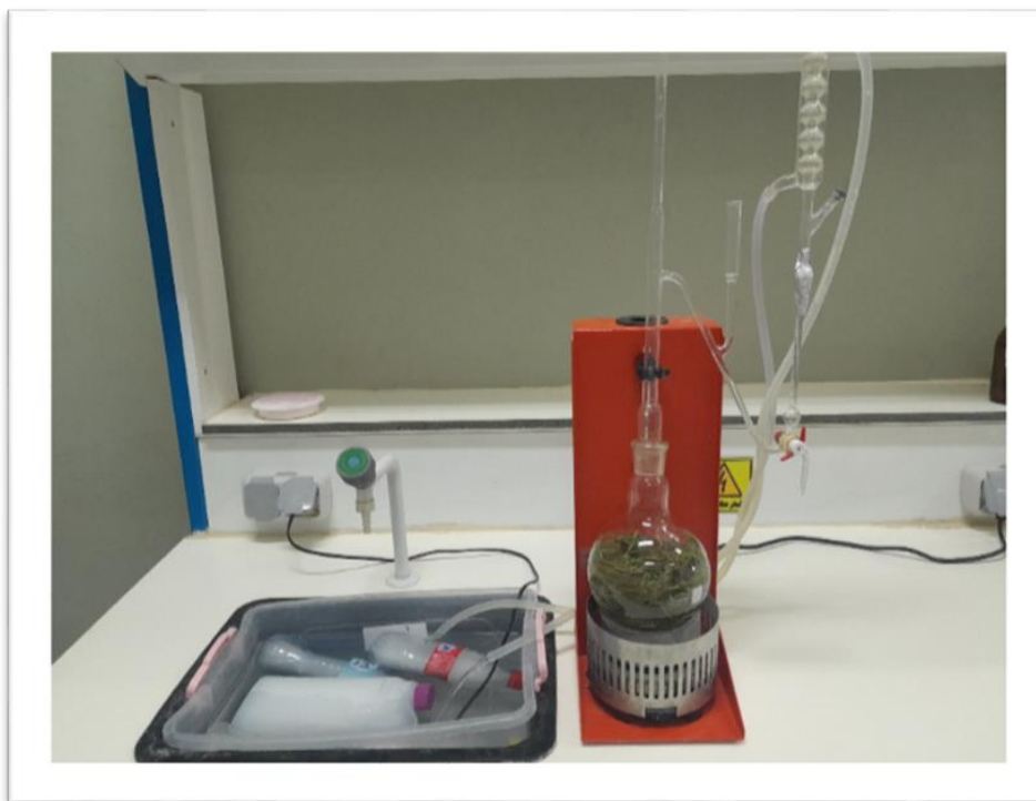
Figure 07: Extraction d'huile de romarin avec appareil Clevenger (photo Original, 2024)
