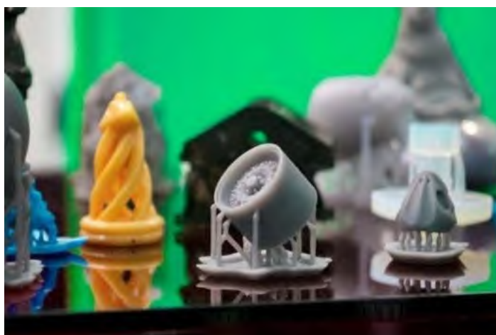
الشكل 14.I : تصنيع مجسمات باستخدام تقنية الطباعة الحجرية المجسمة (SLA) [38].
