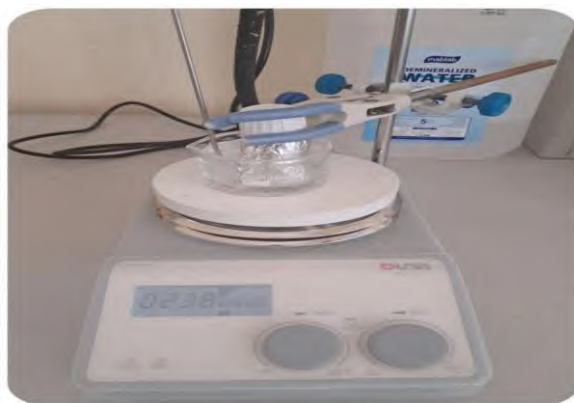
الشكل 1.II : طريقة تحضير الراتنج القابل للبلمرة الضوئية
