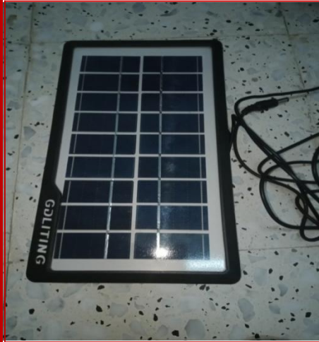
خلية شمسية كهربائية لتغذية المروحة
