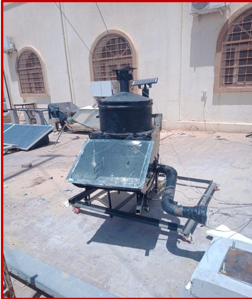
الشكل(III-2): المجفف شمسي ذو الماص المقلوب.
