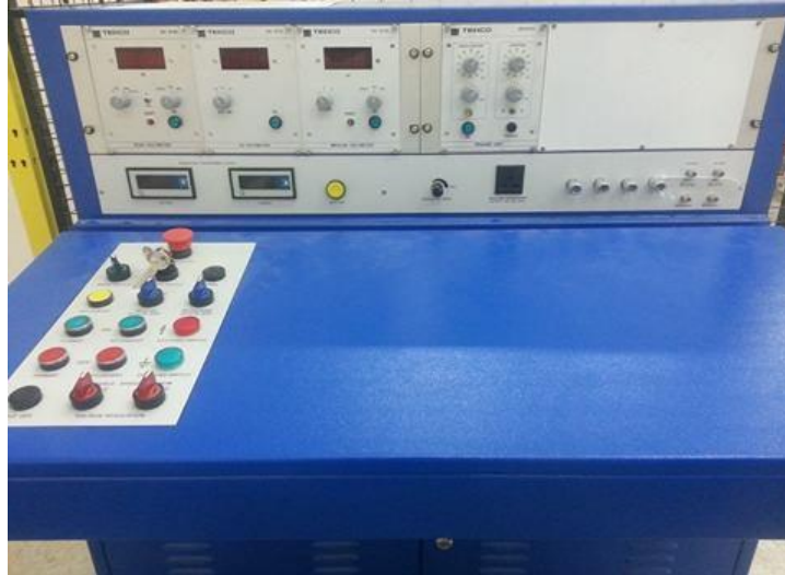
Fig.II.1. Panneau de contrôle utilisé pour effectuer le test de tension de l'air.
