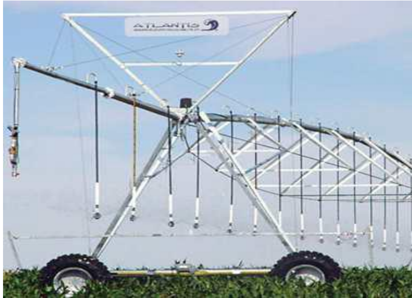
Figure I.11 : Porte-à-faux de rampe d'irrigation. Photo ATLANTIS.
