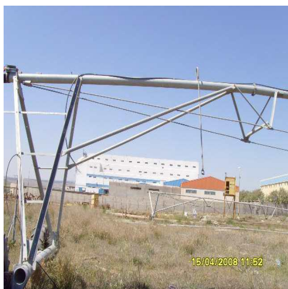
Figure I.8: Tour de travée. Photo IRRAGRIS (gauche). Schématisation des différents éléments d'une tour (droite).
