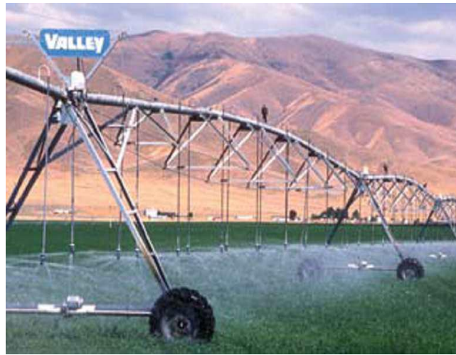
Figure I.6: Travées de rampes d'arrosage. Photo VALLEY[4].
