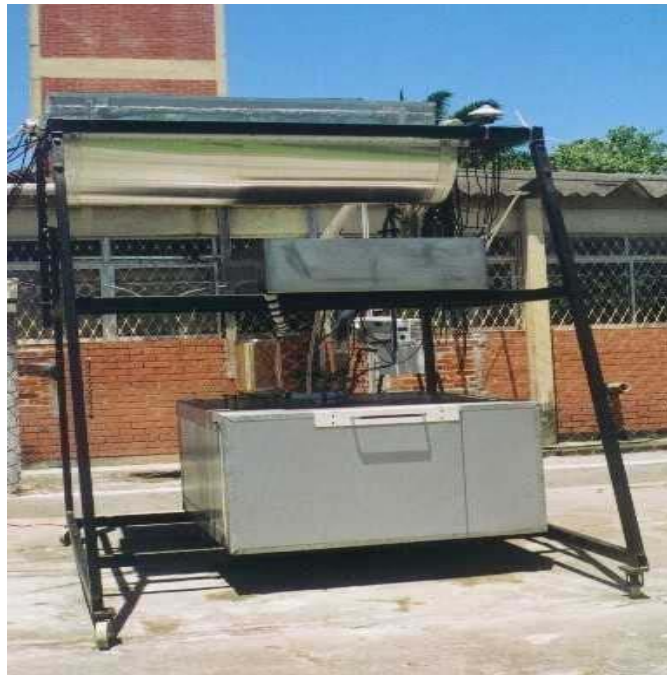
Figure IV-5: Vue générale du prototype de production de glace réalisé au Brésil
