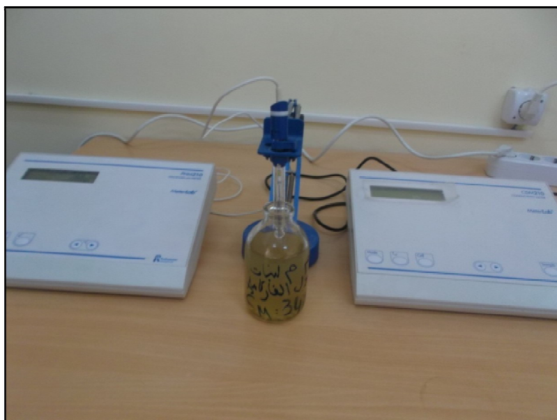
شكل 12: طريقة قياس الناقلية الكهربائية و PH للمستخلصات المستعملة (زماني؛ قعري؛ ضو؛ 2014)
