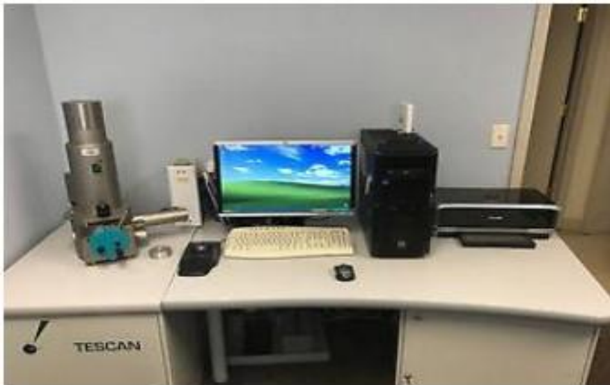
الشكل (2-21): صورة للمجهر الإلكتروني الماسح .
