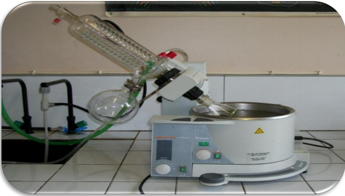
الشكل IV.2: جهاز التبخير الدوراني Rotavapour.
