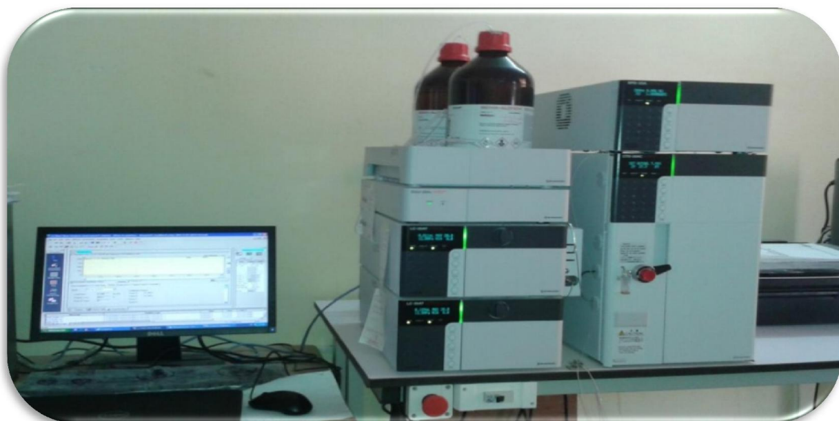
الشكل 4.IV: جهاز كروماتوغرافيا السائلة عالية الأداء (HPLC) .
