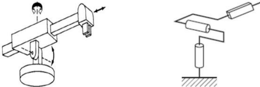
Figure I.16. Structure d'un robot sphérique. [7]
