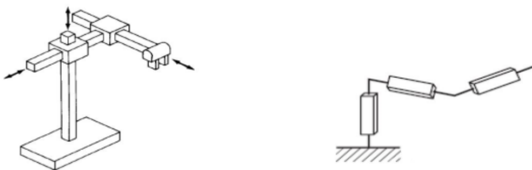
Figure I.14. Structure d'un Robot cartésien. [7]
