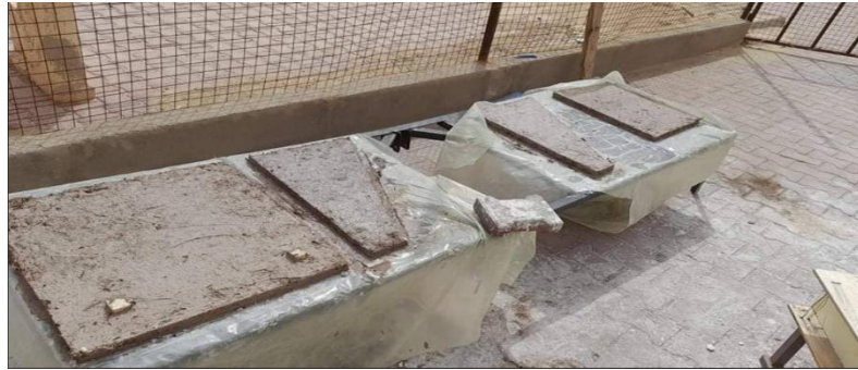
Figure IV.5 : Plaque d'isolant (composite fibres des palmiers et Plâtre)
