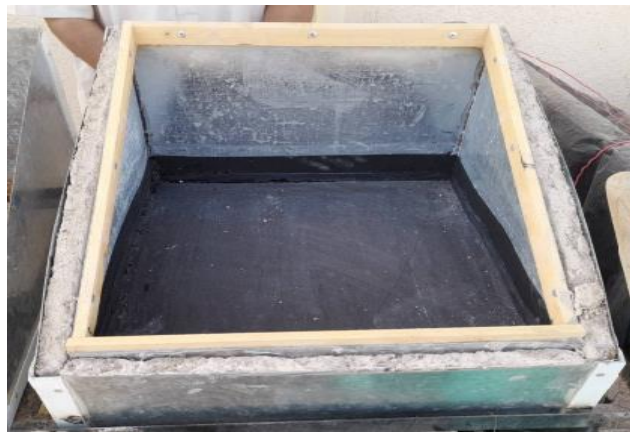
Figure. IV.6: distillateurs solaires avec isolation en Fibres de palme mélangées à du plâtre
