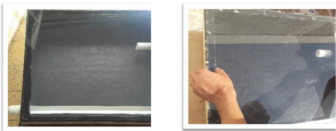
Figure.I.8: Distillateur solaire a une seule pente [10].
