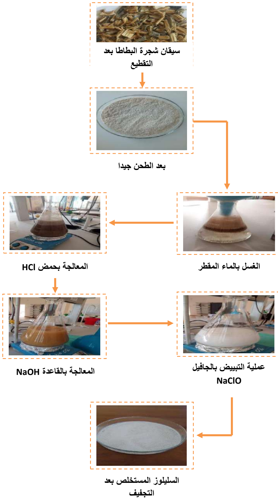
الشكل (3-IV) : يوضح مراحل إستخلاص السليولوز من سيقان شجرة البطاطا
