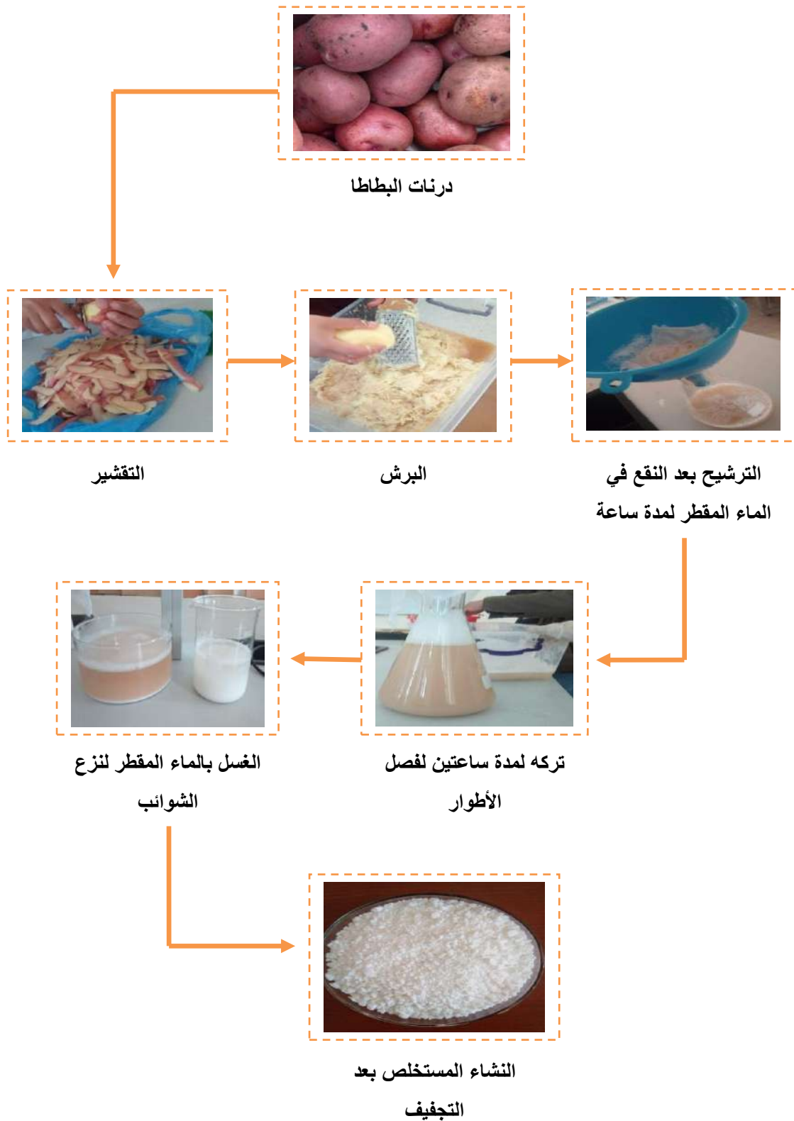
الشكل (2-IV) : يوضح مراحل إستخلاص النشاء من درنات البطاطا
