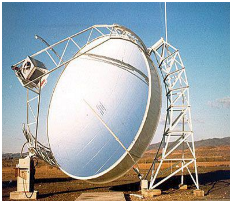
Figure I-9 Capteur parabolique avec moteur Stirling.
