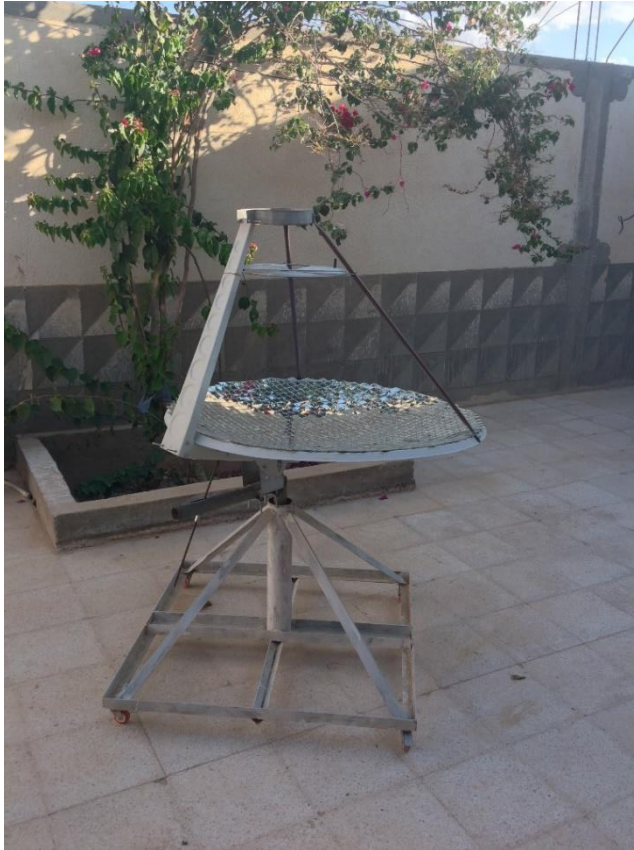
Figure III-11 Vue générale du cuiseur réaliser
