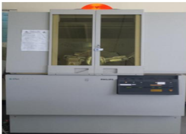
Figure II.6: Photographie de l'appareil utilisé pour réaliser DRX [17]
