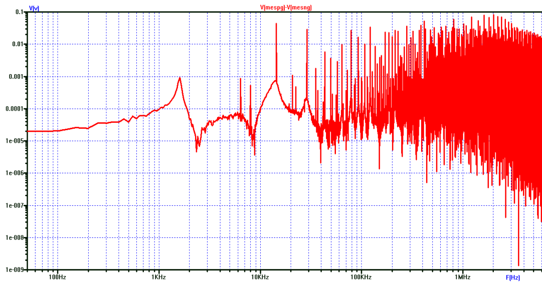
Figure (IV.24): Représentation spectrale des perturbations de tension MD sortant d'un hacheur.
