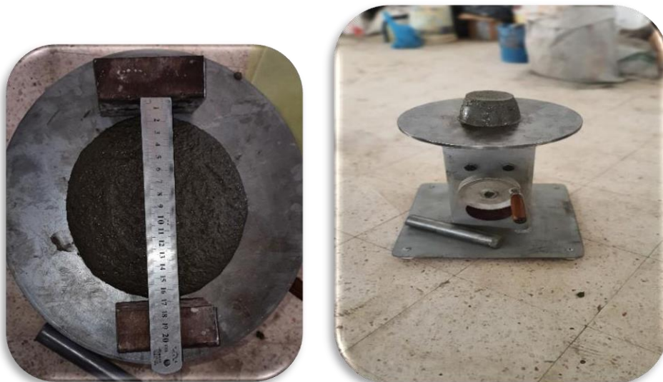
Figure II.20: Étalement du mortier à la table à secousses.
