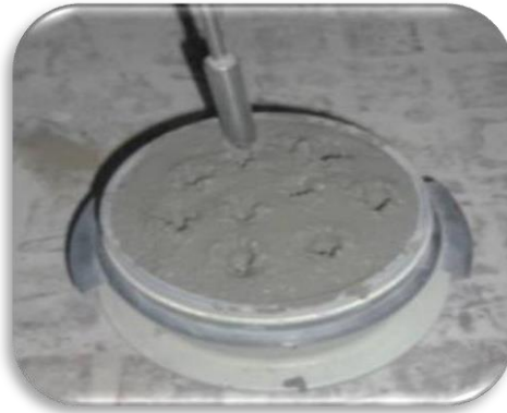
Figure II.22. Mise en place de la deuxième couche
