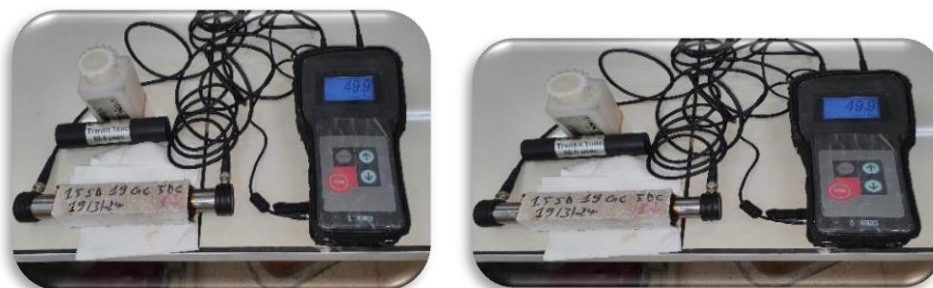
Figure. II.27. Essai d'auscultation dynamique.
