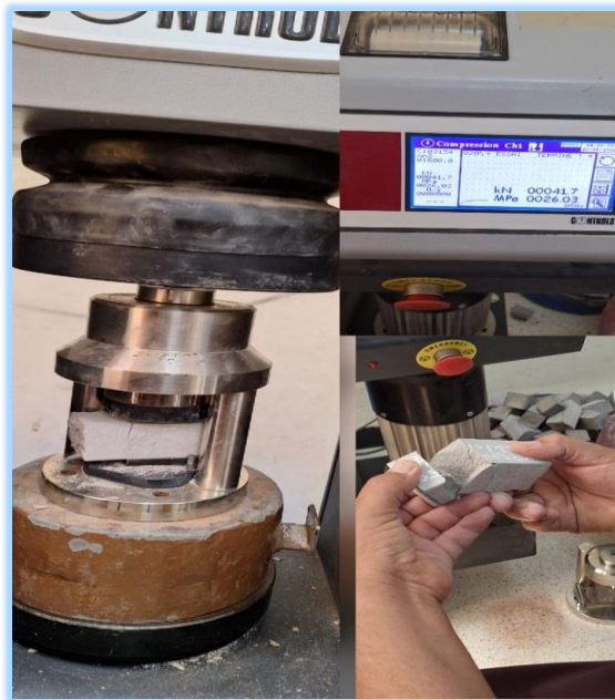
Figure II.14 : Matériels utilisés pour l'essai de compression
