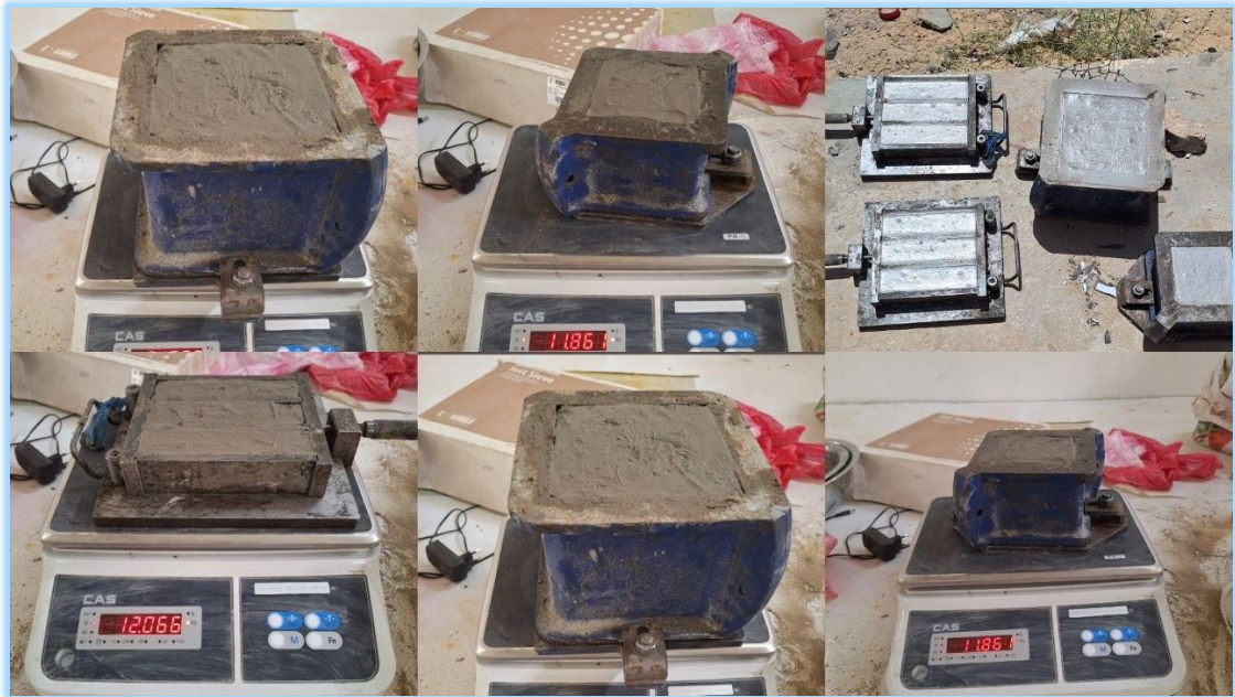
Figure II.7 : Coulage du mortier et arasement de la surface des éprouvettes
