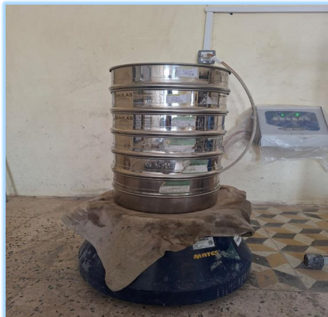
Figure II.18 : Tamiseuse utilisée pour l'essai d'analyse granulométrique.
