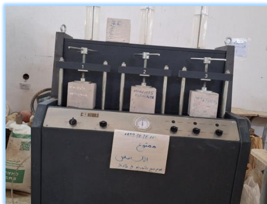
Figure II.16 : Appareil de mesure de la perméabilité à l'eau sous pression.
