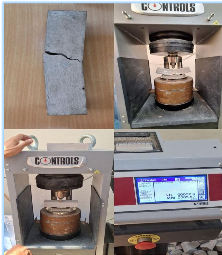
Figure II.13 : Matériels utilisés pour l'essai de traction par flexion à trois points.
