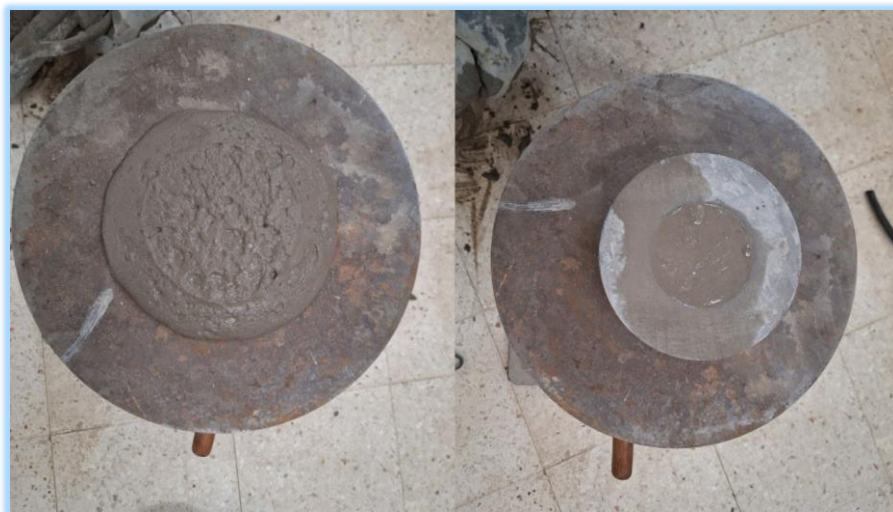
Figure II.9 : Méthode de mesure de l'étalement à la table à secousses
