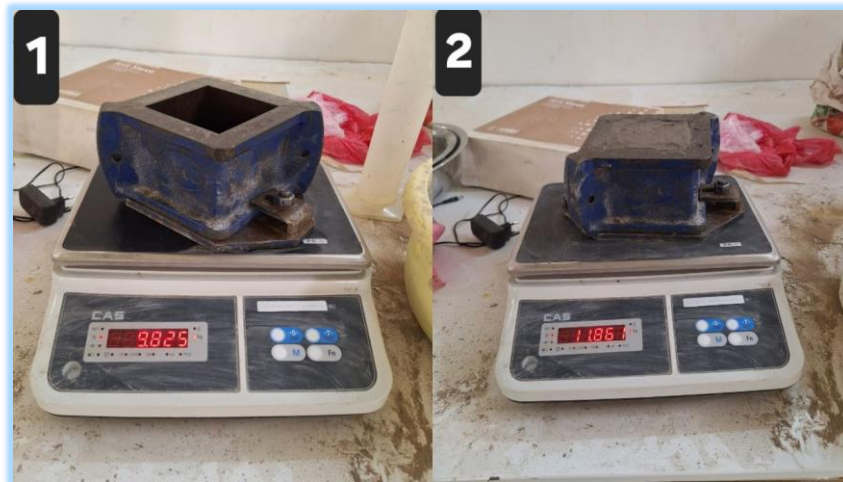
Figure II.10 : Mesure de la masse du moule vide et rempli de mortier pour le calcul de la masse volumique
