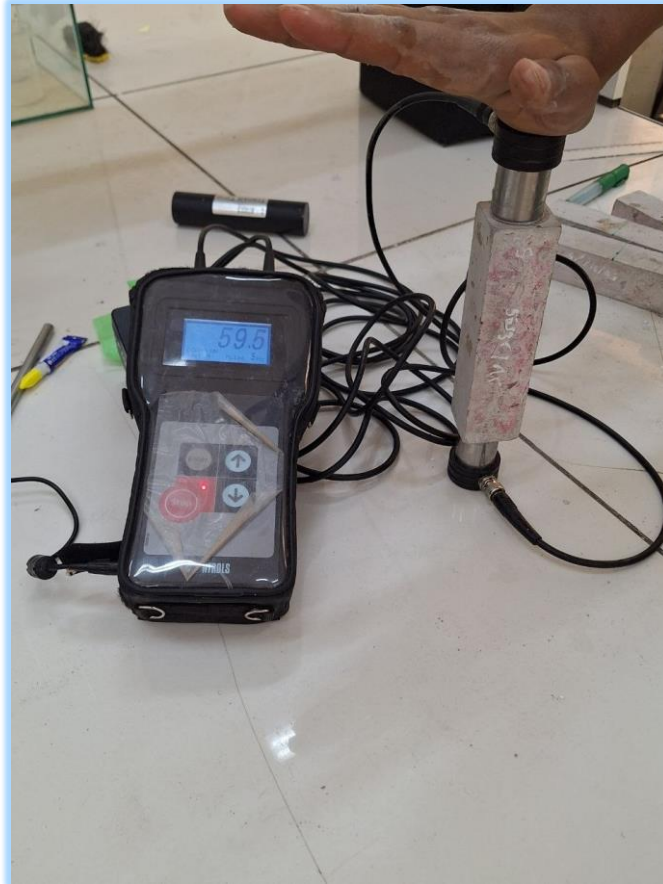
Figure II.11 : Mesure de la vitesse d'impulsion ultrasonique du mortier étudié
