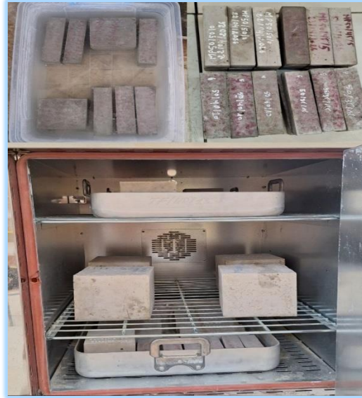
Figure II.15 : Le principe expérimental de l'absorption d'eau
