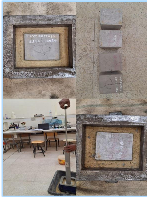
Figure II.17 : Méthode de mesure de l'essai aux chocs
