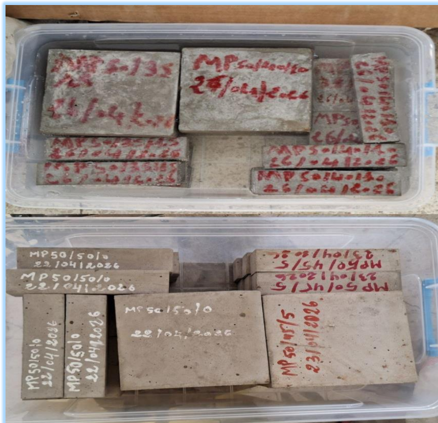
Figure II.8 : Conservation des éprouvettes en cure humide pendant 28 jours
