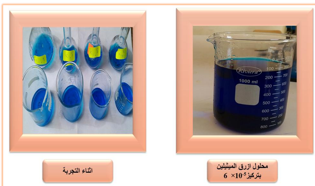
الشكل (10.III): تجربة امتصاص أزرق الميثيلين بالهلام الهوائي.
