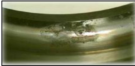
Figure (II.6): Défaut de roulement – corrosion[BEL17].
