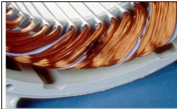
Court-circuit entre phase ou entre bobine [SW5]
