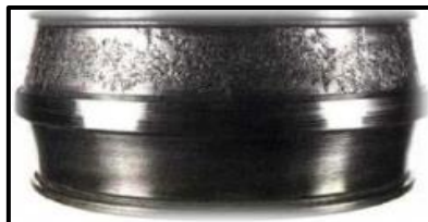
Figure (II.5) : Défaut de roulement – écaillage[BEL17].
