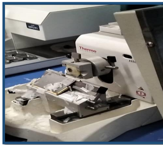
Figure 36: Image du microtome utilisé pour disséquer les organes en vue d'une étude histologique.
