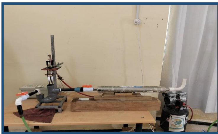
Figure 33: La figure illustre le système de connexion expérimental entre le dispositif de magnétisation et le dispositif à plasma froid.
