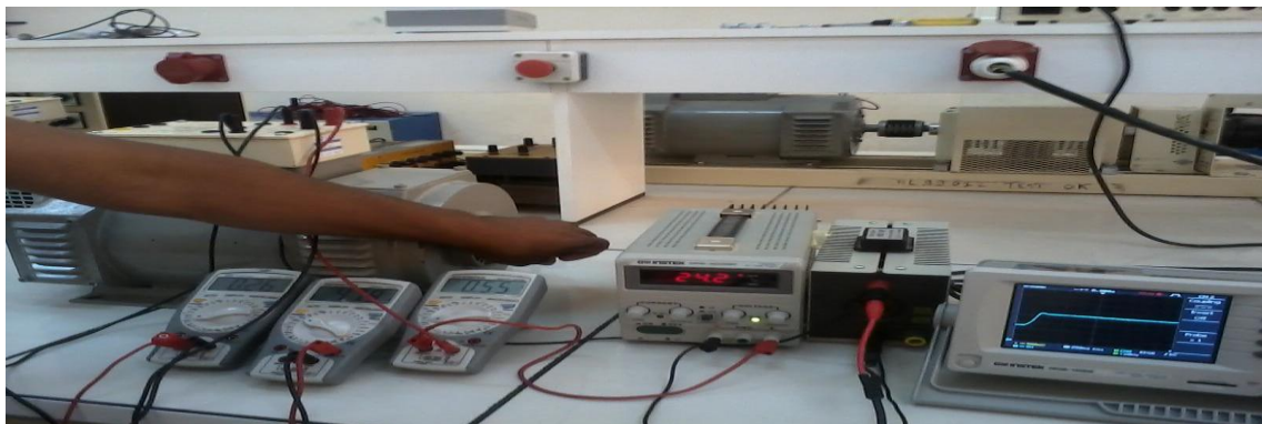
Figure III-4 - Essais pour Obtenir la valeur de l'inductance d'induit (Rotor bloqué)
