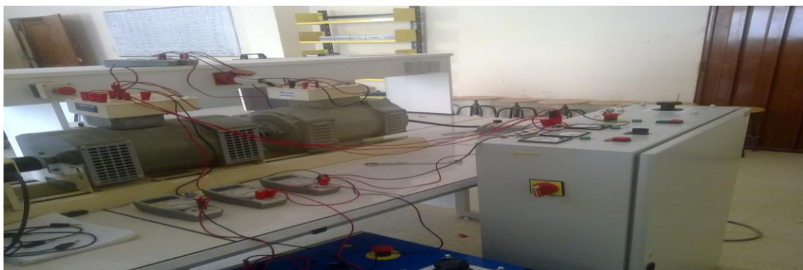
Figure III-3- Essais pour Obtenir la valeur de la résistance d'induit
