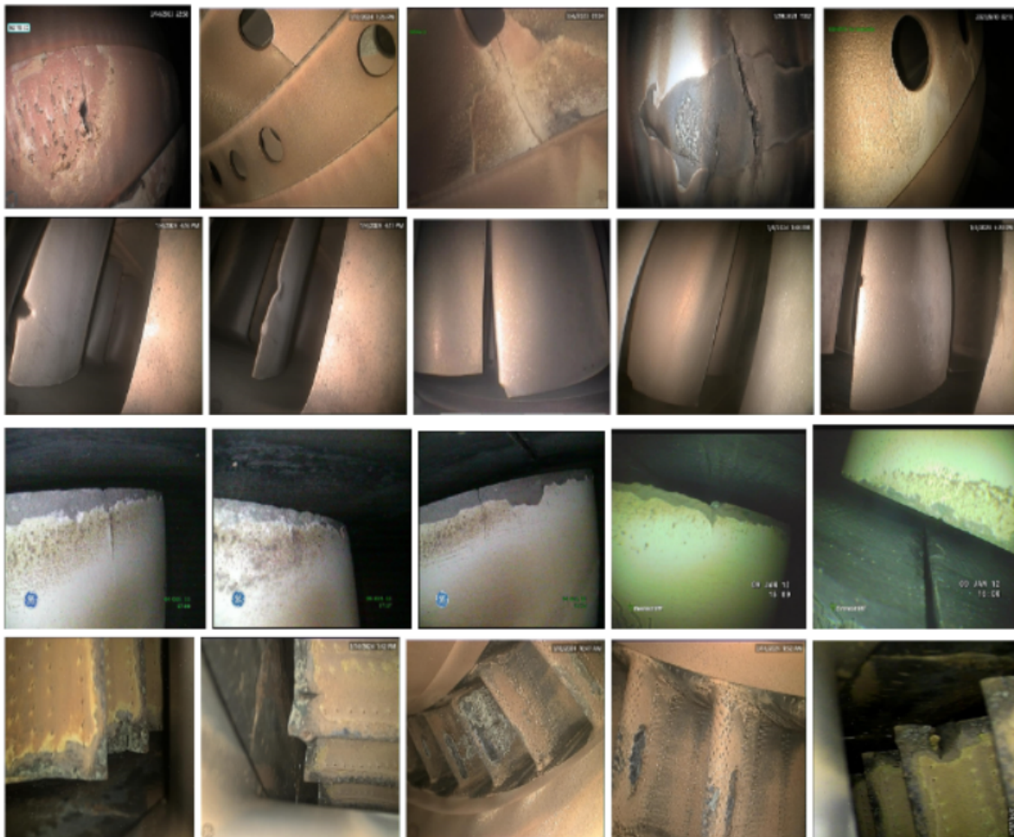
FIGURE III.2 – Exemples d'images de dommages surgissant au moteur d'avion.
