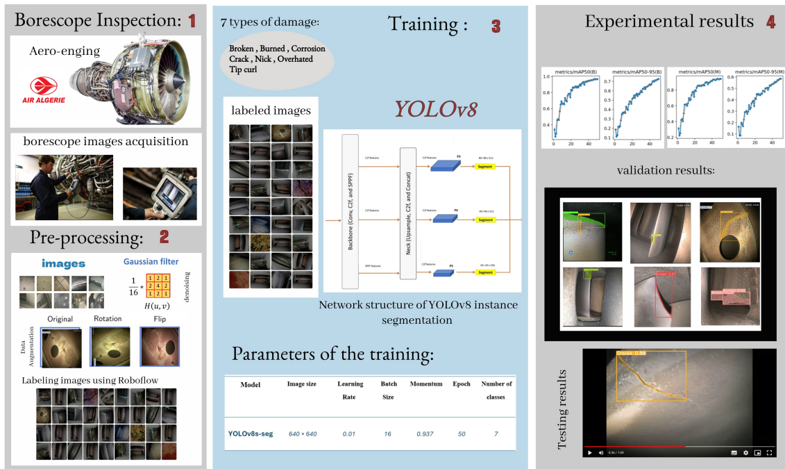
FIGURE III.1 – Architecture générale du système proposé de détection automatique des dommages du moteur aérien.
