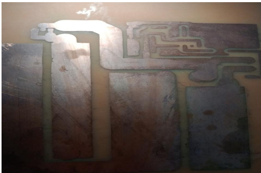
Fig( III-1) Circuit imprimé du hacheur réalisé
