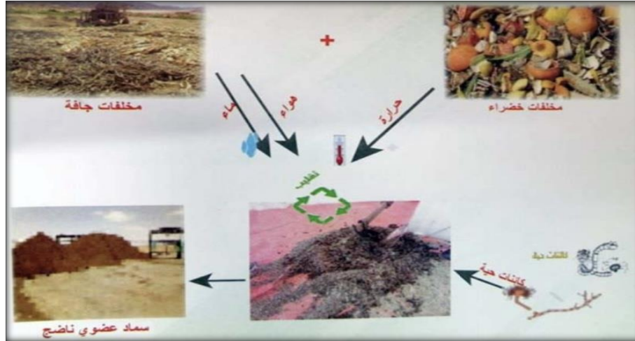
الوثيقة ١٣: رسم توضيحي لآلية تصنيع الكومبوست (رشيد ناصر وآخرون، ٢٠١٨)
