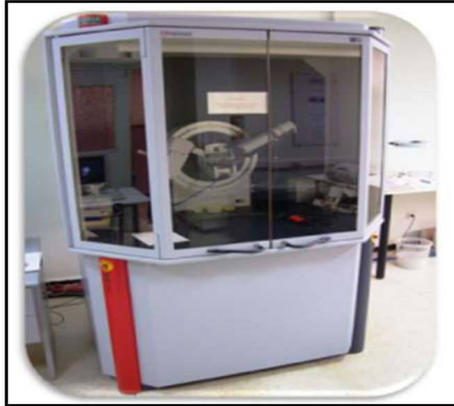
الشكل (13-II): صورة لجهاز الانعراج Brucker Siemens D8.
