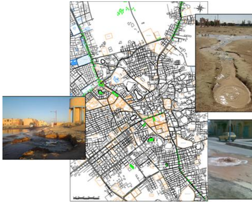
Figure 22. Exemples de fuites du réseau d'A.E.P dans la commune d'El Oued (Miloudi, 2017).
