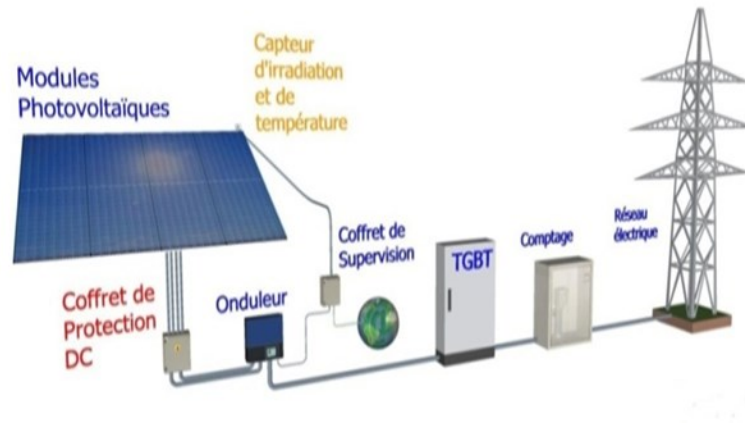
Figure 1.7 : Structure d'un système PV connecté au réseau [10].
