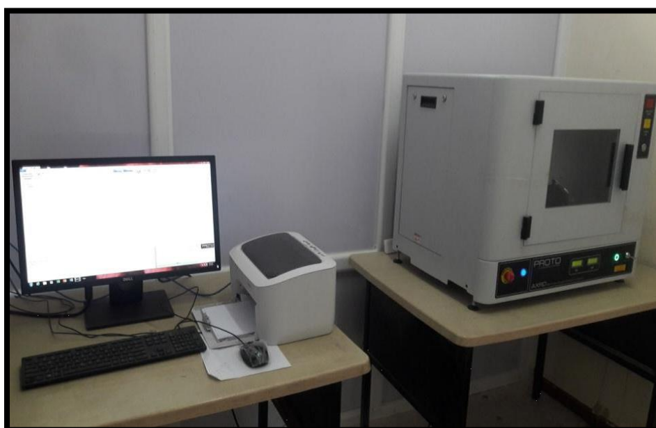
الشكل (III-19): جهاز الانعراج الآلي من نوع PROTO AXRD Benchtop المستعمل في دراسة العينات.
