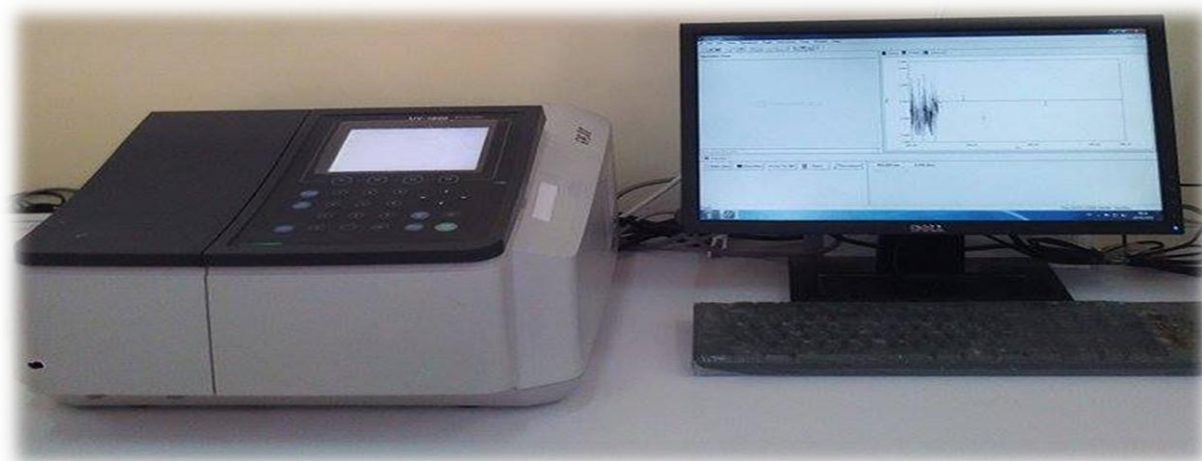
Figure (III.8): photo d'appareil UV-Visible 1800 SHIMADZU
