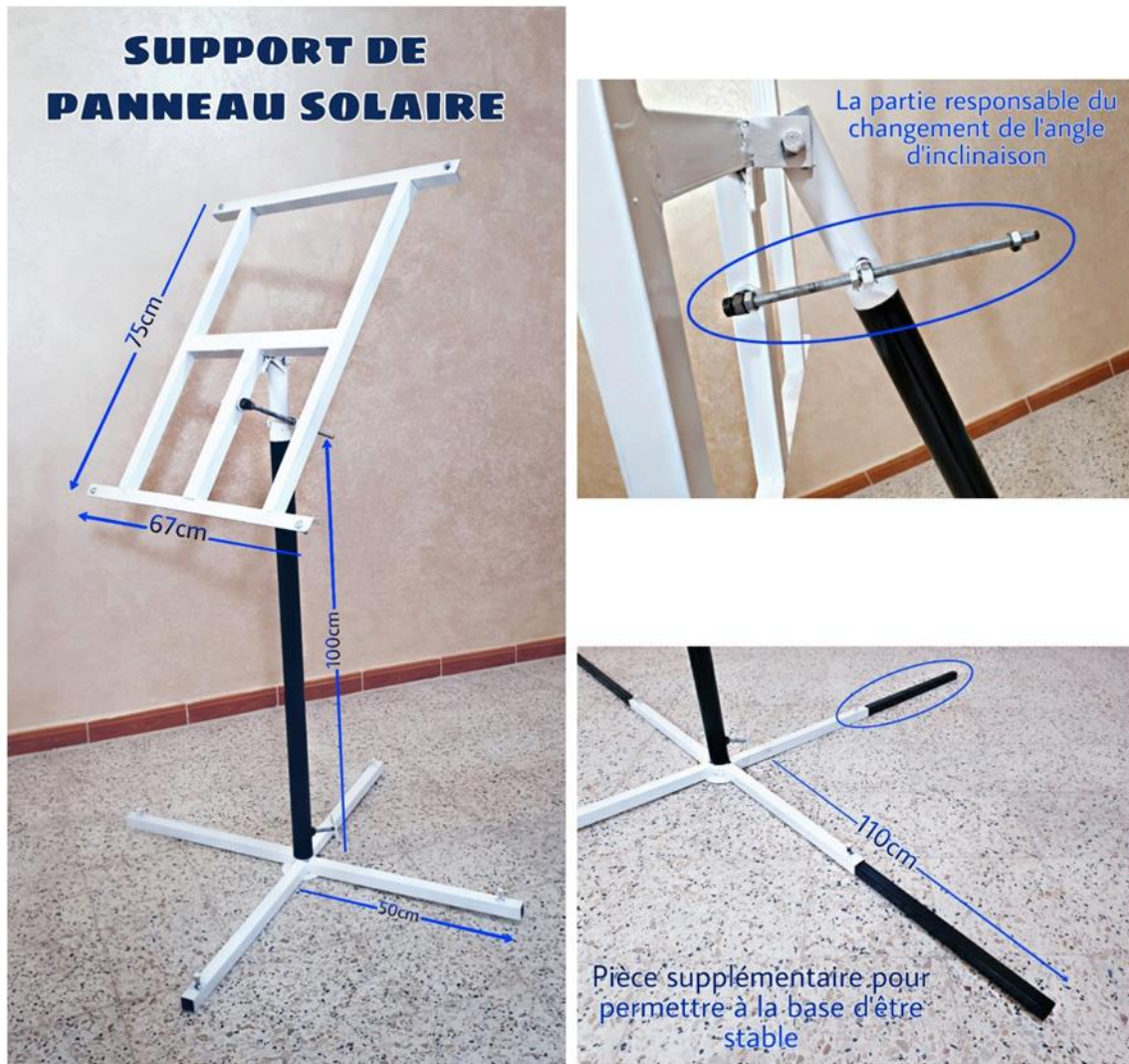
Figure II. 7 : Dimensions et caractéristiques des supports fabriqués.
