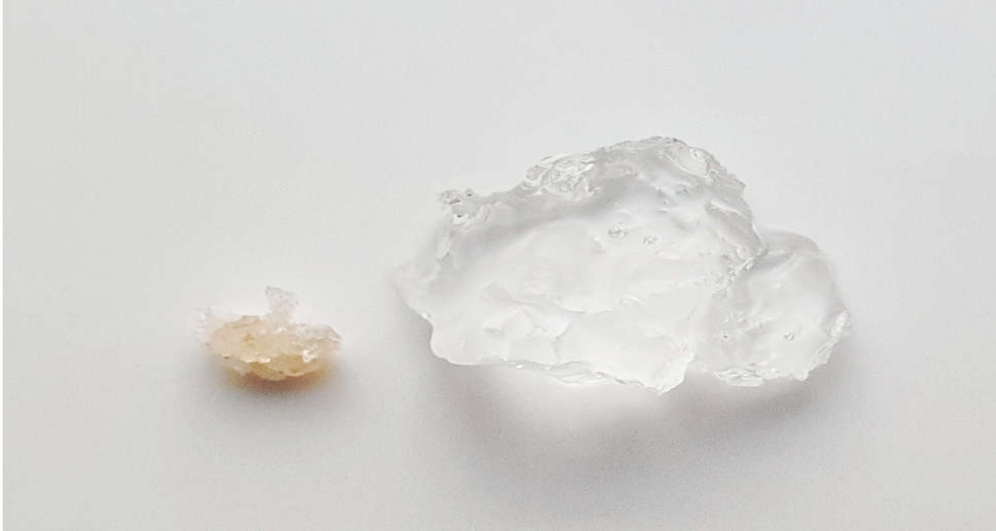
صورة 03: نانو هيدروجيل قبل وبعد امتصاص الماء (Chihani, 2023)
