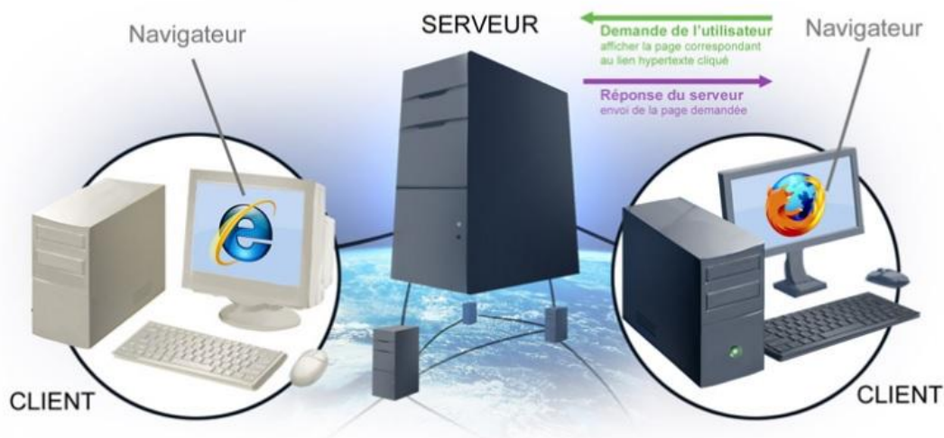
Figure 1 : Fonctionnement d'un site web statique 1 .
