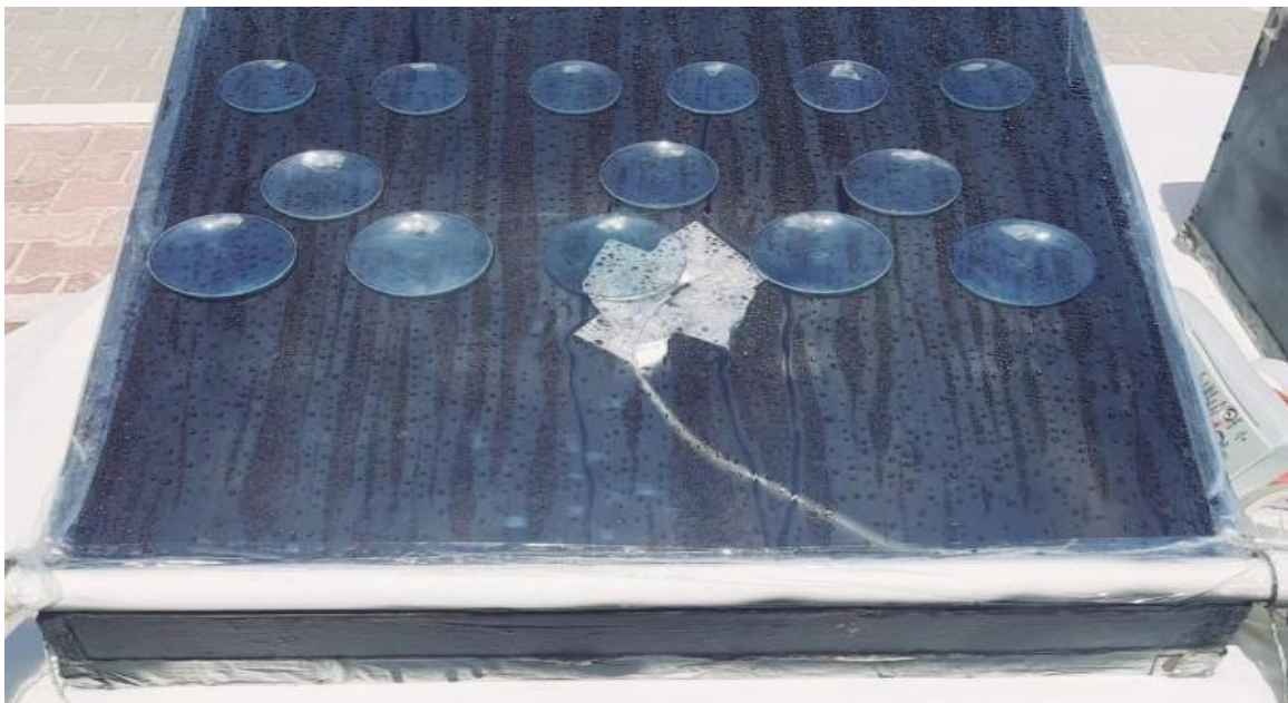
الشكل (2.3): صورة توضح المقطرين الشمسيين أثناء التجربة.
