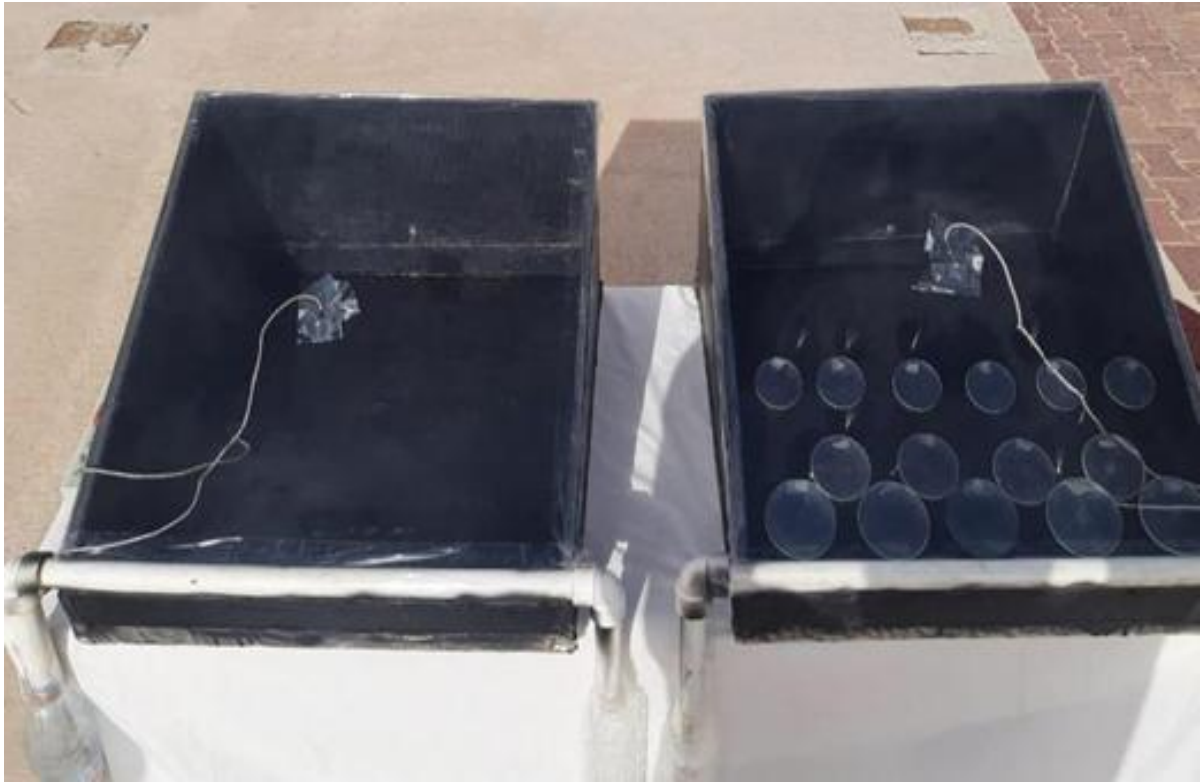
الشكل (3.3): صورة توضح المقطران في بداية التجربة.
