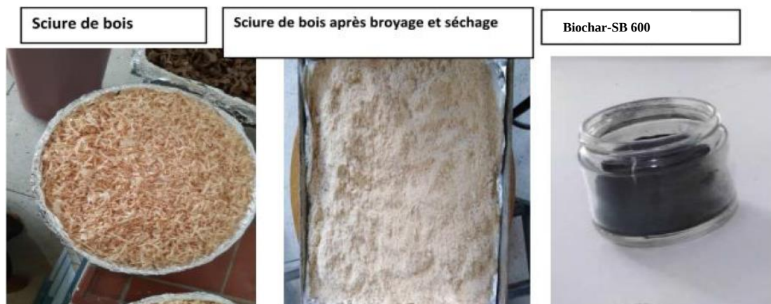
Figure I.1: étapes de préparation de Biochar à partir de sciure de bois
