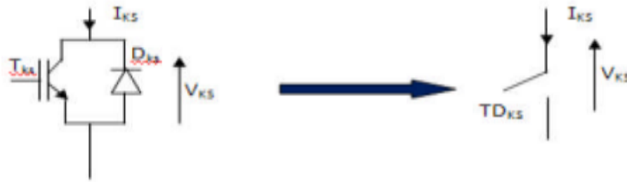
Figure(II.9): Interrupteur bidirectionnel équivalent de la paire Transistor – diode
