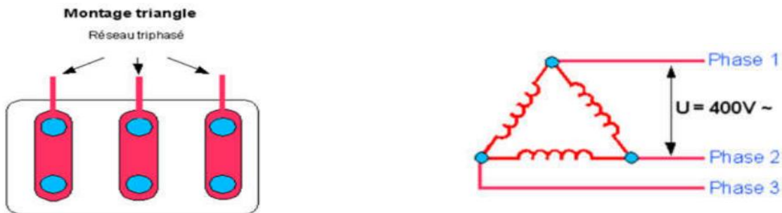
Figure (I.8): Les couplages des moteurs asynchrones triangle [9]
